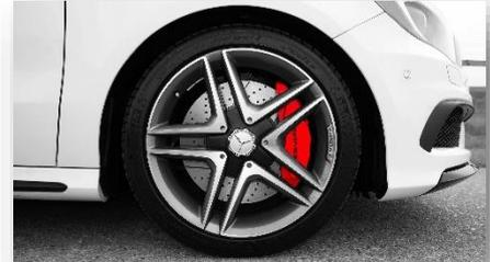
Abbildung 1: Scheibenbremse eines Autos
