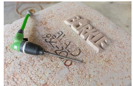
Prozess des Gravierens eines Grabsteins (© Bundesverband Deutscher Steinmetze)
