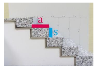
Treppenmodell mit Auftritt und Stufenhöhe © Kai Görder
